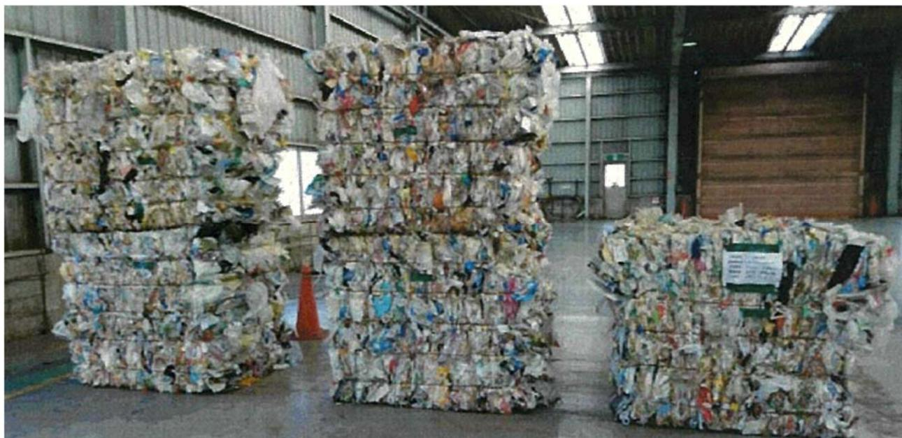
町で集められた「容器包装プラスチック」は、中間処理施設でベール（写真にあるかたまり）として梱包され、リサイクル工場に搬入されます。
